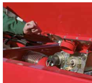
Leeresztő csap a tartály teljes kiürítéséhez
