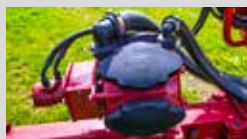
Hidraulikus szivattyú meghajtás
