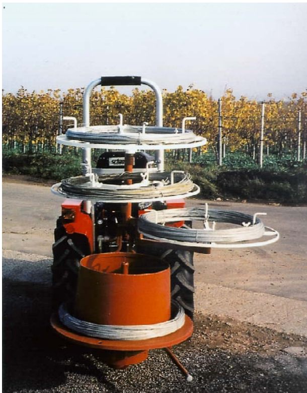
Bild: Drahthaspel ausgerüstet mit 3-fach Schwenkvorrichtung und 3 Einziehringe
