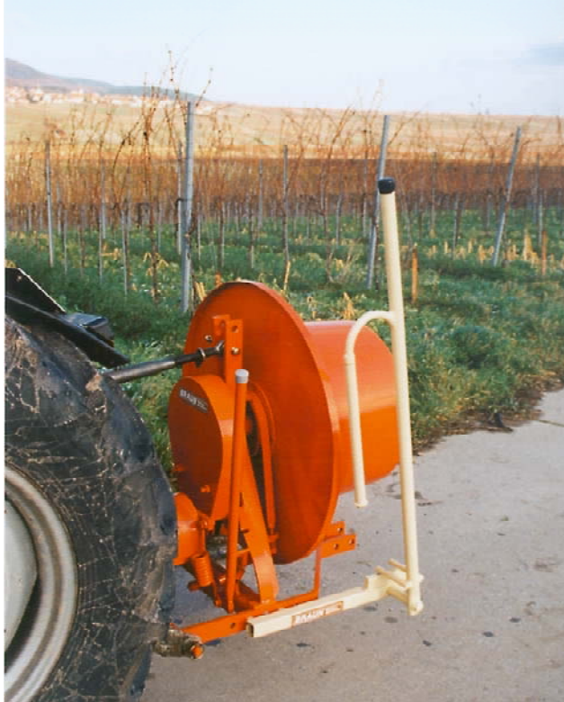
Bild: Drahthaspel ausgerüstet mit Drahtführung
